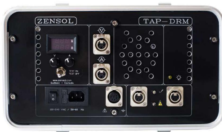
Cet accessoire utilisé avec le TAP-4-PLUS permet d'effectuer des tests de DRM. Corrélation facile entre vibro-acoustique, DRM et courant moteur.
