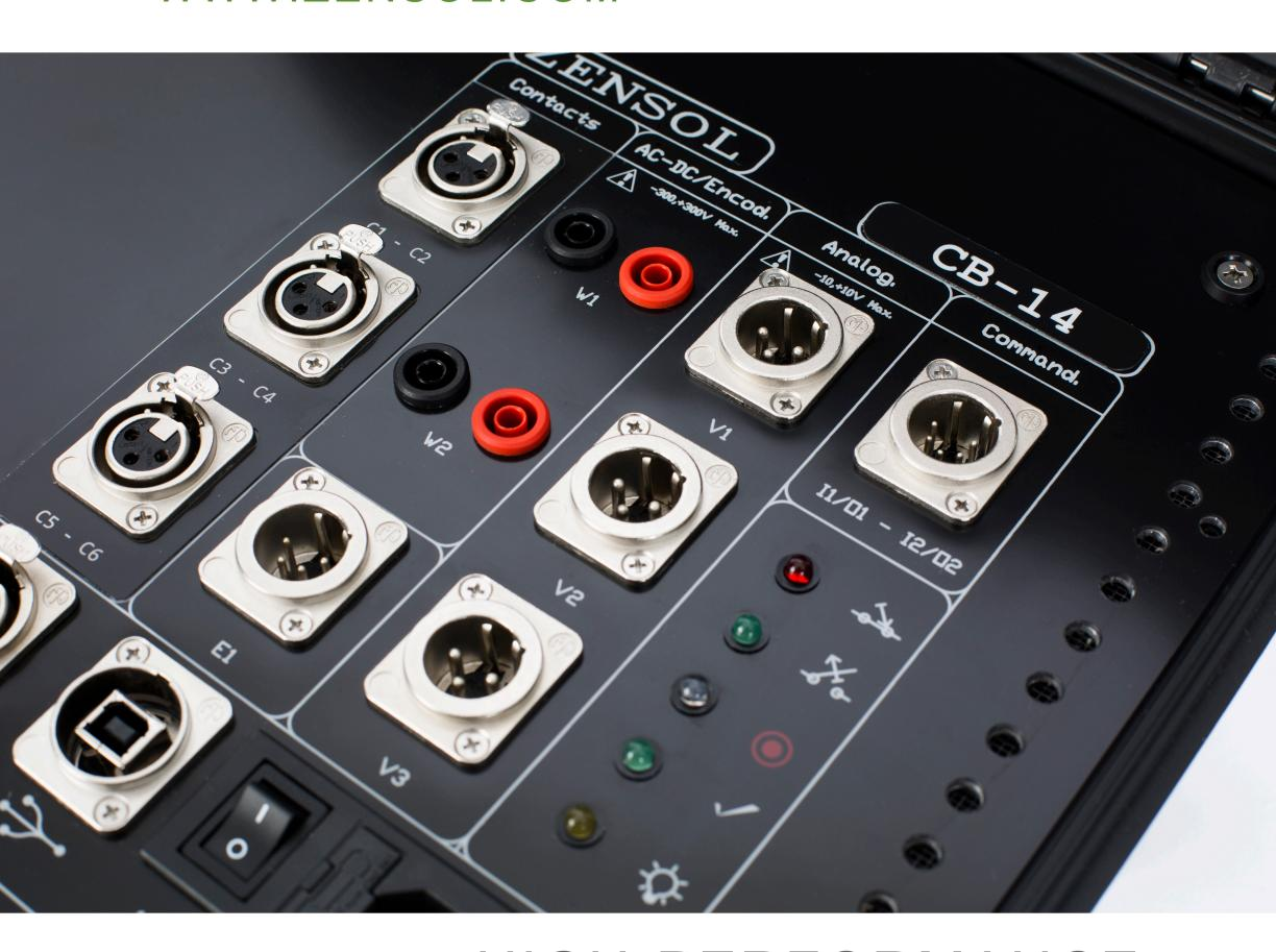
HIGH PERFORMANCE CIRCUIT BREAKER ANALYZER CB14
