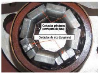
Fig 7 Contacto tulipán en el interruptor de aceite
