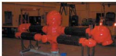
Fig 8 Módulo del interruptor de soplo de aire PKV
