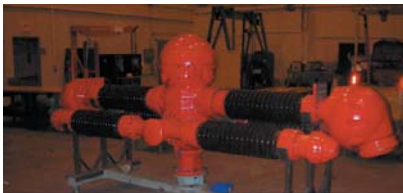
Fig 8 PKV air-blast breaker module
