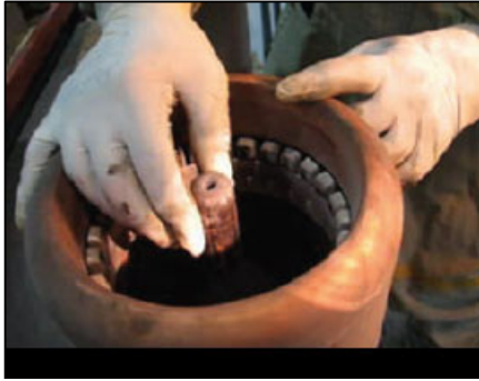
Fig. 5. Desenroscado de la punta de tungsteno
