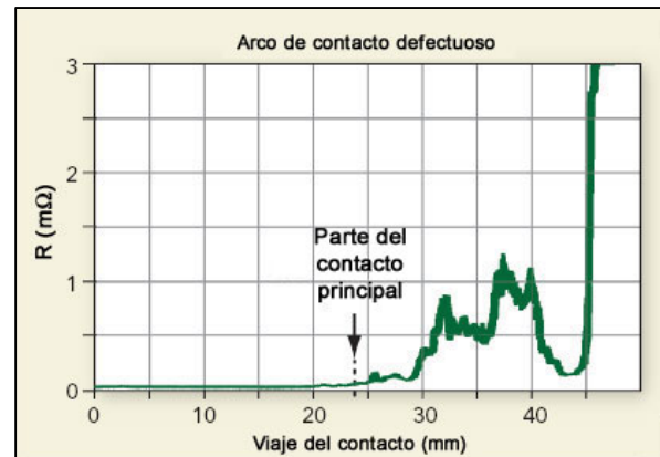
Fig. 2. Una curva anormal de la resistencia dinámica
